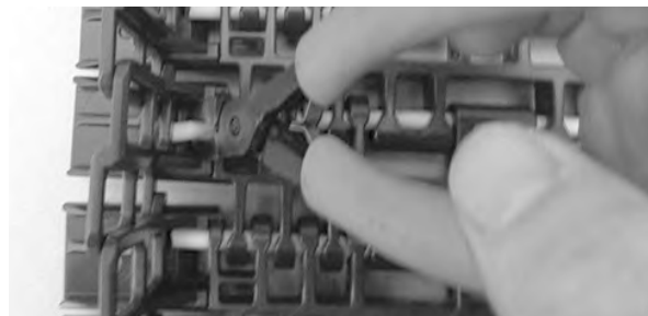
図 353: ベルトからロッドを引き出す
