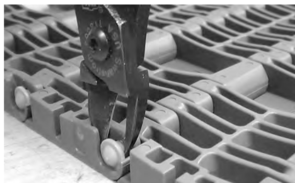
図 268: ロッドレットの切り落とし
