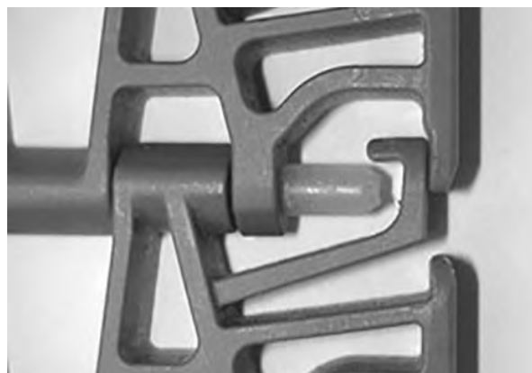
図 248: ロッドが保持機構を通過していることを確認する
