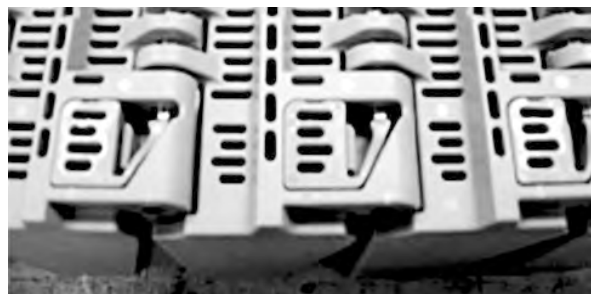
図 105: 保持機構が閉じていることを確認する
