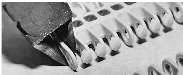
図 26: 最も外側のリンクを切り離す
