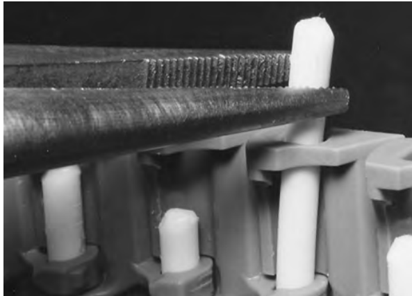
図 149: ベルトからロッドを引き出す
