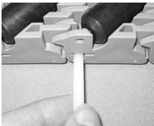
図 224: ロッドをヒンジに挿入する
