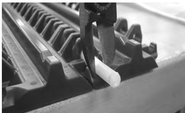
図 72: ベルトからロッドを引き出す
