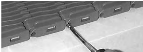
図 44: ベルトからロッドを押し出す
