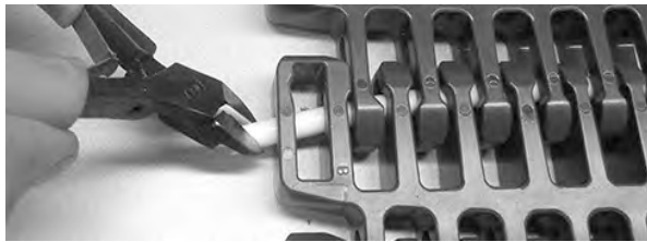
図 334: ベルトからロッドを引き出す
