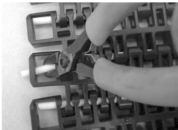
図 357: 保持機構を通過するまでロッドの押し込む
