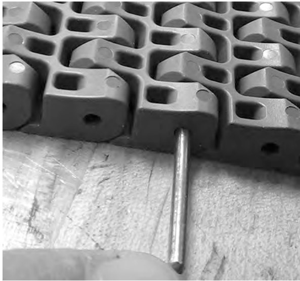
図 269: ロッドレットとロッドをベルトから押し出す
