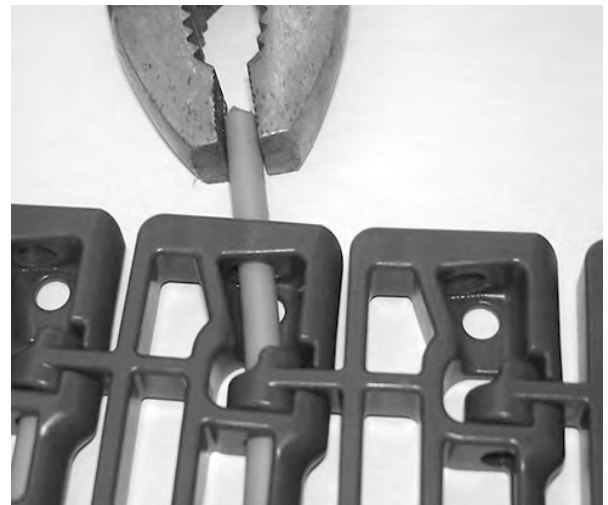
図 126: ベルトからロッドを引き出す
