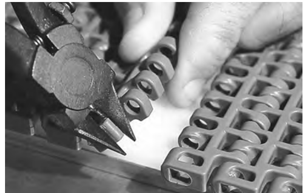
図 152: ベルトからエッジを切り落とす
