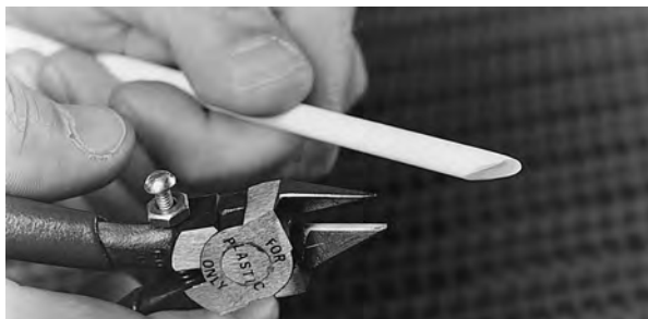
図 14: 角度をつけてロッドを切り取る
