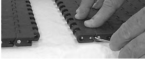
図 162: スライドロックを閉める
