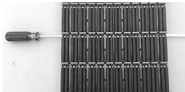
図 243: ベルトからロッドを押し出す
