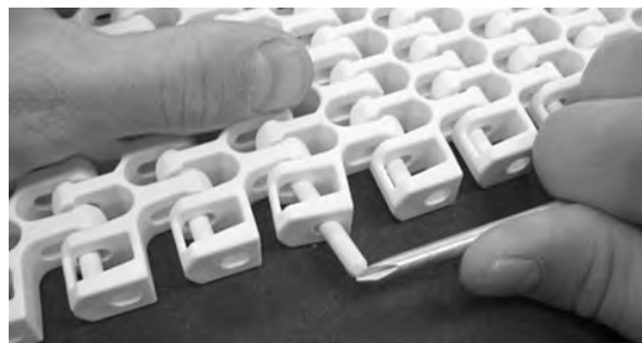
図 288: 保持機構を通過するまでロッドの押し込む
