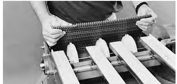
図 11: リターン側走行路からベルトを送る
