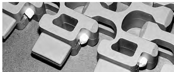
図 272: ロッドが完全に挿入されていることを確認する
