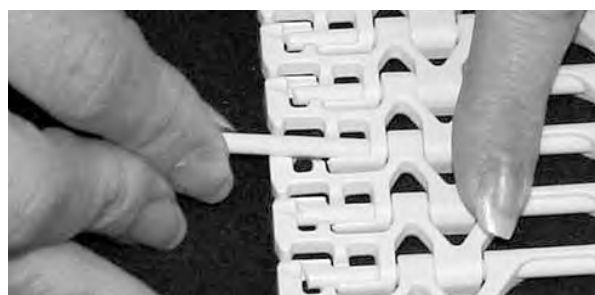
図 169: ロッドをヒンジに挿入する
