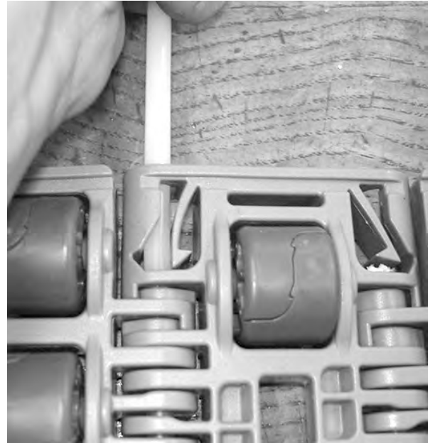
図 221: ベルトからロッドを押し出す
