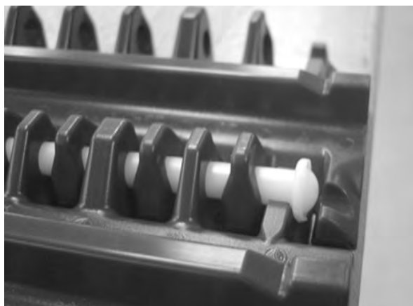
図 70: ロッドが保持機構を通過していることを確認する
