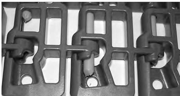
図 124: ロッドが完全に挿入されていることを確認する
