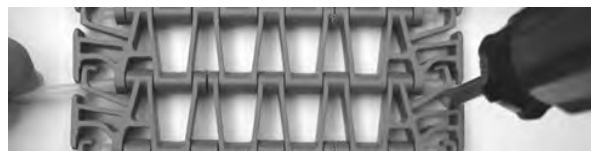
図 250: ベルトからロッドを押し出す
