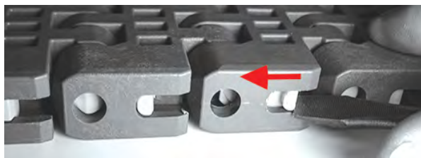
図 158: スライドロックを閉める
