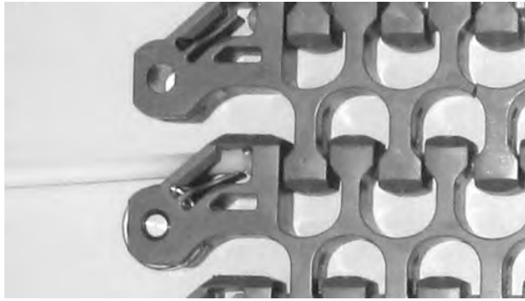
図 281: ベルトからロッドを押し出す
