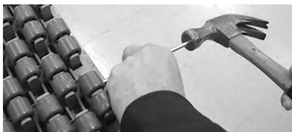
図 194: ベルトからロッドを押し出す
