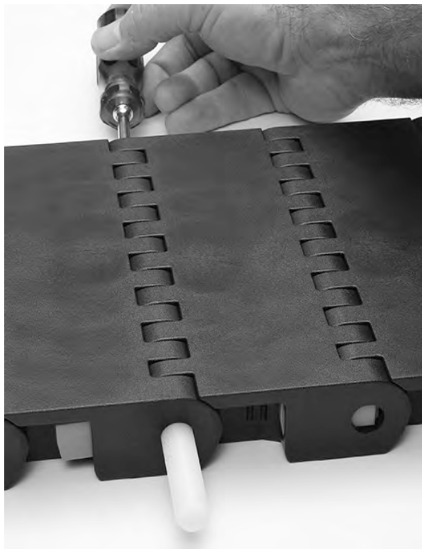
図 263: ベルトからロッドを押し出す
