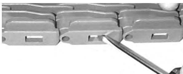
図 42: スライドロックを閉める
