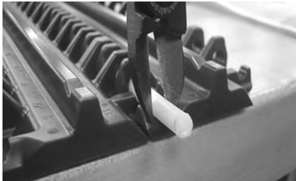
図 101: ベルトからロッドを引き出す
