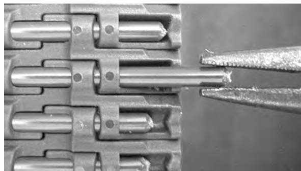
図 57: ベルトからロッドを引き出す
