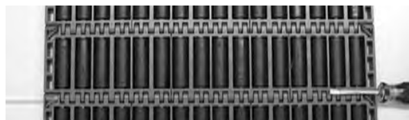
図 239: ベルトからロッドを押し出す
