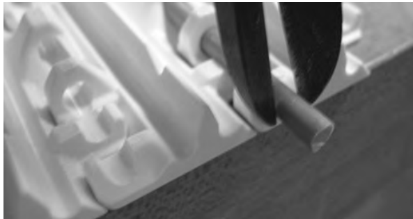
図 183: ベルトからロッドを引き出す
