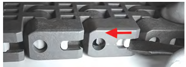
図 156: スライドロックを閉める
