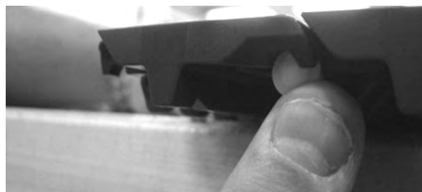
図 98: 保持機構を通過するまでロッドの押し込む
