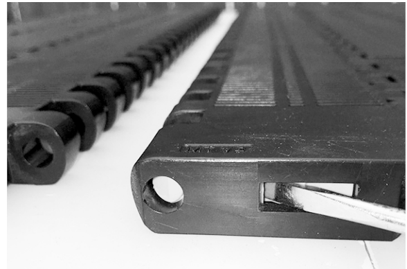
図 214: スライドロックを閉める
