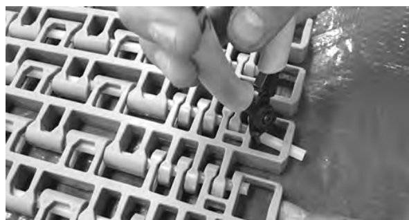
図 340: ベルトからロッドを引き出す
