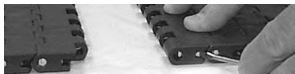
図 160: ドライバーを使用して、スライドロックを閉める
