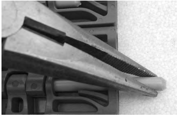
図 131: ベルトからロッドを引き出す
