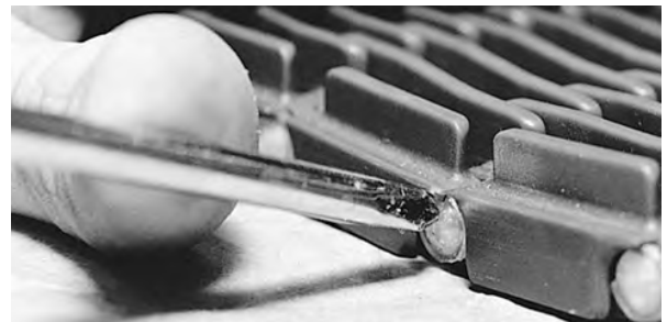
図 112: ロッドがスナップロックを通過していることを確認する
