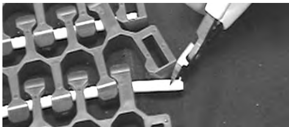
図 312: ベルトからロッドを引き出す
