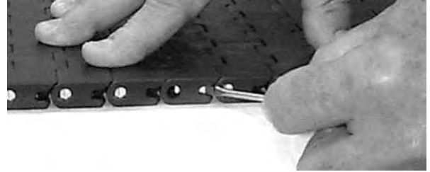
図 165: スライドロックを閉める
