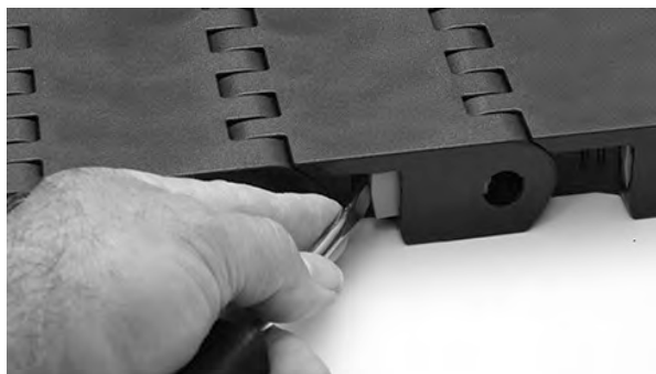
図 256: スライドロックを閉める
