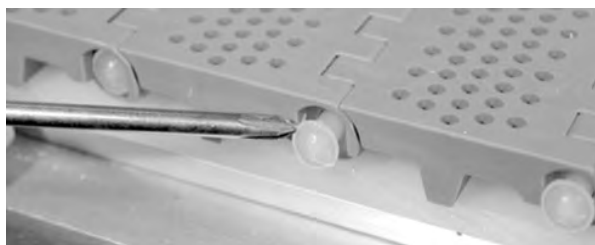
図 63: ロッドをベルトに押し込む
