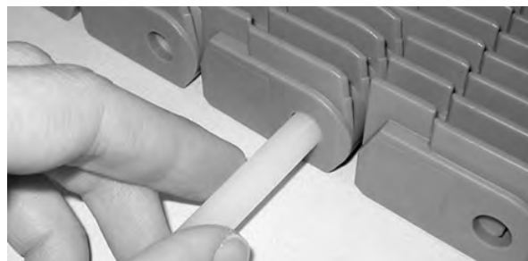
図 218: ベルトからロッドを引き出す
