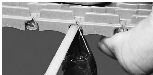
図 24: ベルトエッジと一直線になるようにロッドをカットする
