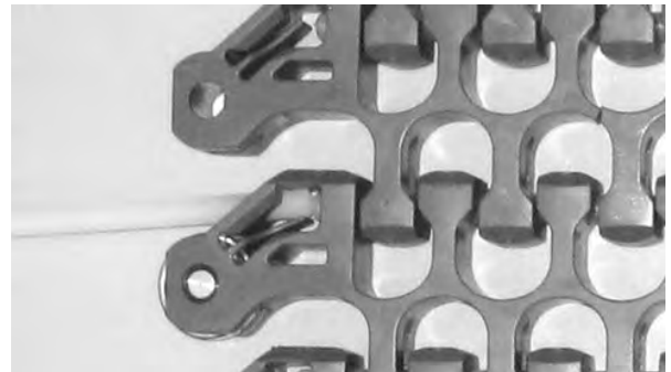
図 299: ベルトからロッドを引き出す
