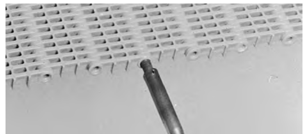
図 30: ロッド穴を閉じる
