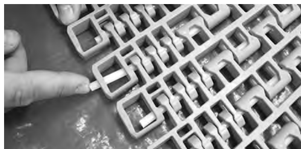
図 338: 保持機構を通過するまでロッドの押し込み
