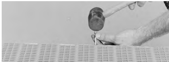
図 32: ベルトからロッドを押し出す
