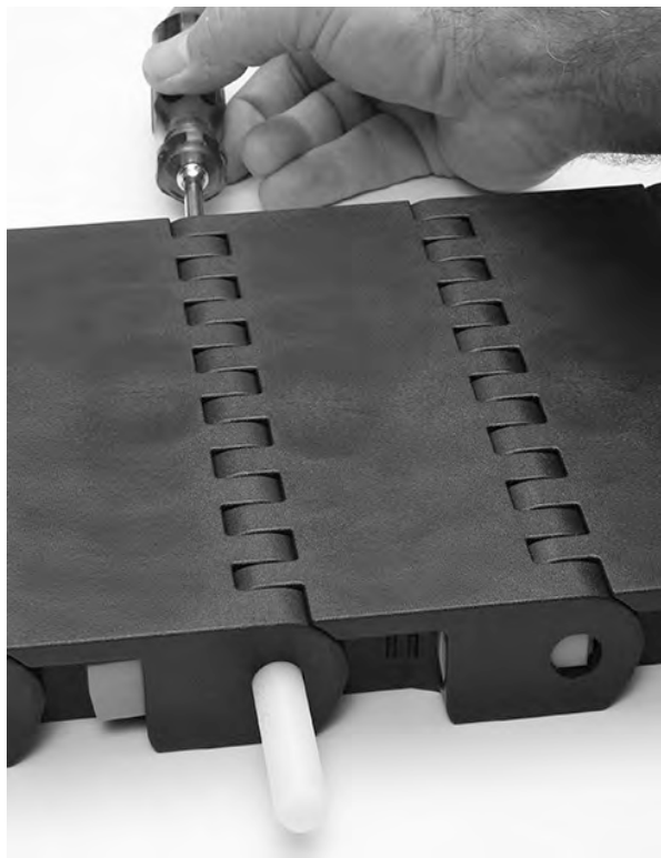
図 259: ベルトからロッドを押し出す
