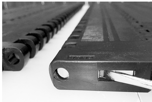
図 211: スライドロックを閉める
