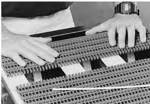
図 13: ベルトの端を合わせて押し込む
