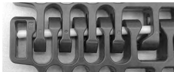
図 315: ロッドが保持機構を通過していることを確認する
