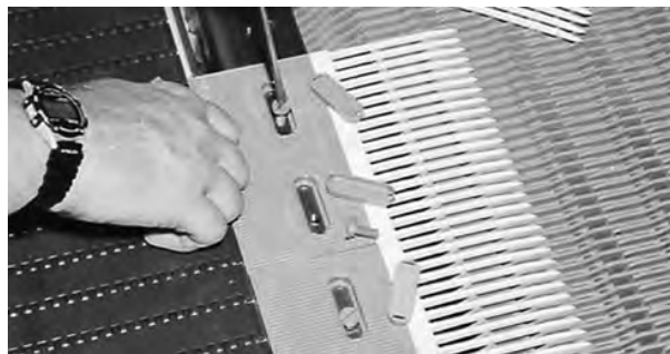
図 18: イントラロックプラスチックボルトを使用してフィンガートランスファープレートを取り付ける
