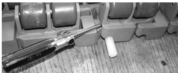
図 195: ベルトからロッドを引き出す
