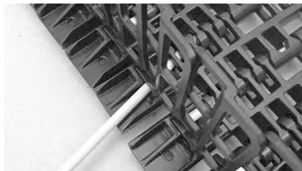
図 364: ロッドをヒンジに挿入する
