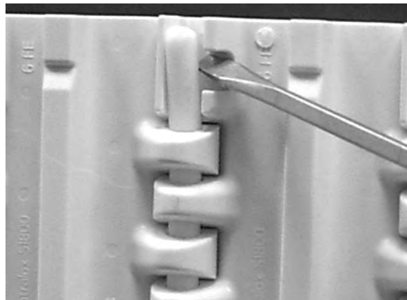
図 206: ロッドを保持機構から持ち上げる
