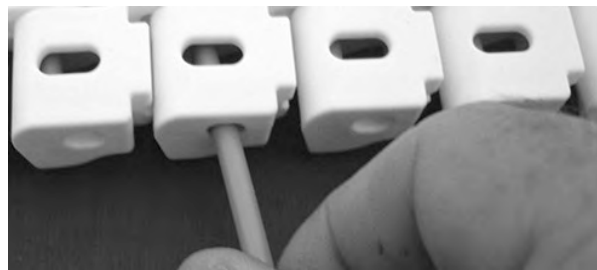
図 282: ロッドをヒンジに挿入する
