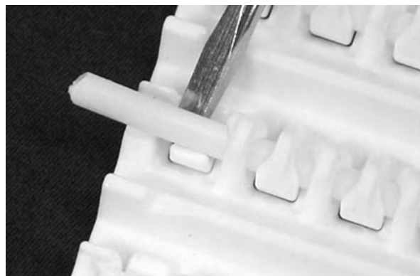
図 176: ロッドを保持機構から持ち上げる
