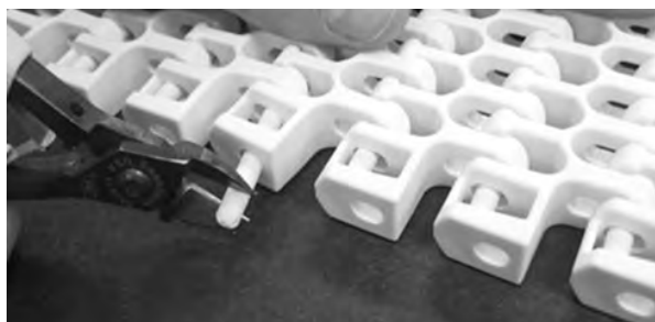
図 291: ベルトからロッドを引き出す
