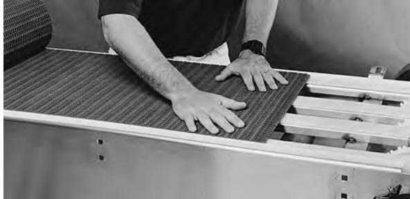
図 8: 駆動側端からベルトを送る
