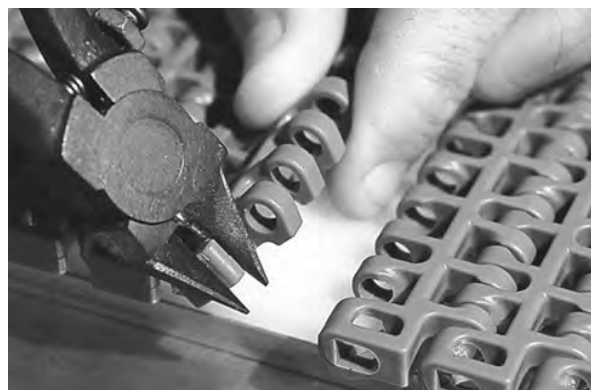
図 142: ベルトからエッジを切り落とす
