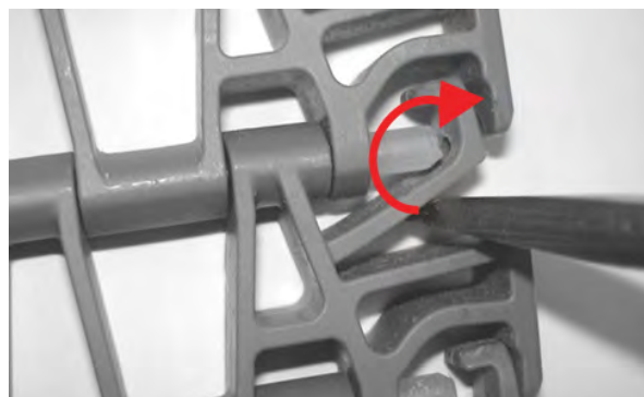
図 249: ドライバーを回して、保持機構を開いたまま保持する
