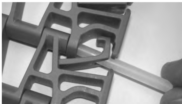
図 246: ロッドをヒンジに挿入する
