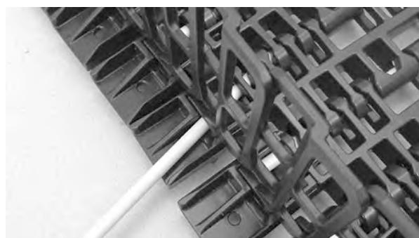
図 350: ロッドをヒンジに挿入する
