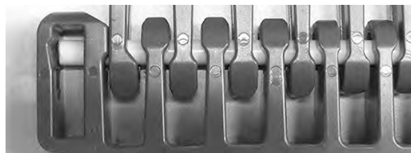
図 332: ロッドが保持機構を通過していることを確認する
