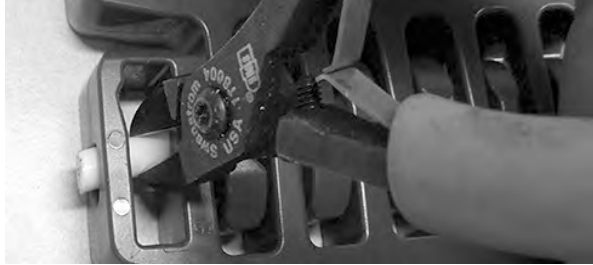
図 333: オクルードされた穴を越えるまでロッドを外側に押し出す
