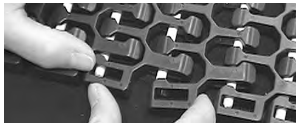
図 307: ベルトエッジを通過するまでロッドを押し込み、ロッドの上でフラッシュエッジをカチッと閉じる
